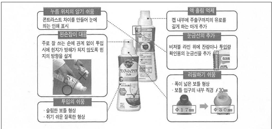
[그림 5] 원푸시 계량용기의 기타 설계 포인트
