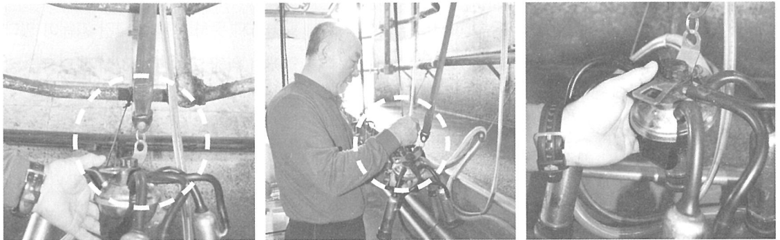
착유기에 안전벨트를 달아서 착유시에는 잡아당겨 사용, 사용하지 않을 때에는 다시 당겨올려 고정시킨다.
