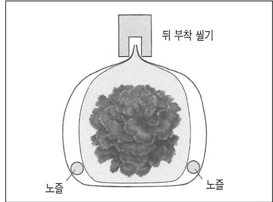
[그림 4] 뒤 부착 씰 시의 단면도(a~a')
