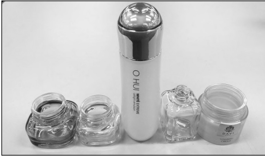
[그림 2] 인젝션블로우 방식의 헤비블로우 용기
