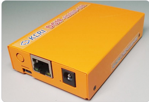
전기연구원이 개발한 IEC 61850 기반 태양광발전 시스템 인터페이스 모듈.
