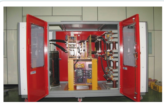
그림 4 22.9kV/630A급 하이브리드 초전도 한류기 시작품
