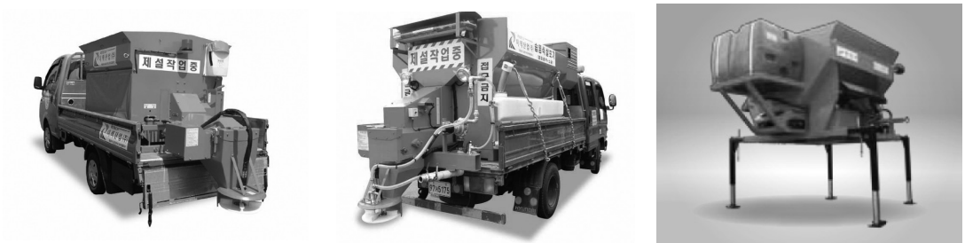
그림 3. 탈·부착식 살포기를 차량 적재함에 탑재하여 녹이기 작업 수행
