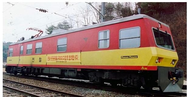
그림 4 전차선 마모를 측정하는 한국철도공사의 전철시험차 Fig. 4 KORAIL catenary recording car which measured the contact wire wear
