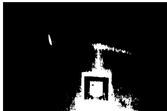
그림 6. 단순 이진화이미지(조명에 취약) Fig. 6 Simple Binary image(vulnerable to luminance)
