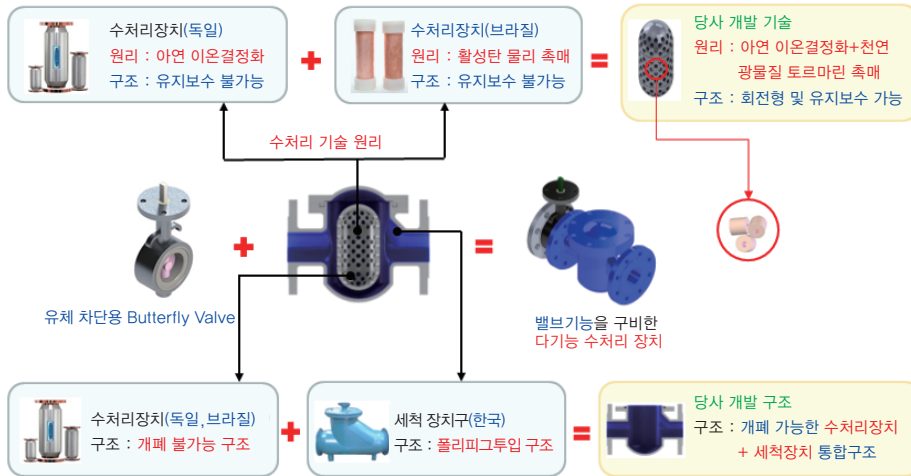
[그림 3] 다기능 수처리 장치 세부 구조
