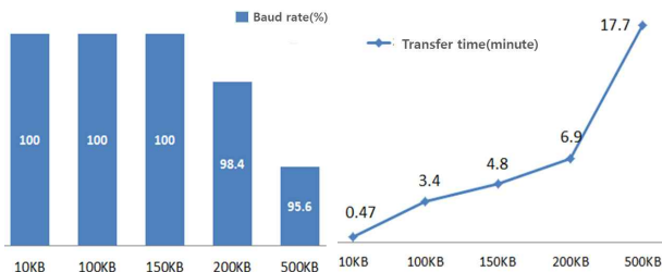
그림 19. HF Radio 데이터 통신 모듈 성능 시험 결과 Fig. 19. Results of performance test on HF radio data communication module.
