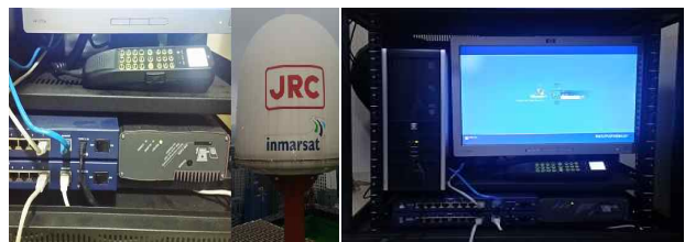
(a) FBB 통신 장비 Inmarsat FBB module (b) FBB 기반의 선박 서버 VCS server
