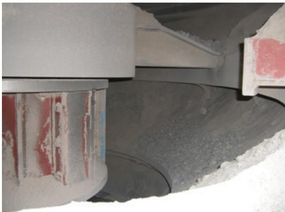
사진 1. 록온록타입(Rock on Rock) 파쇄실 형상
