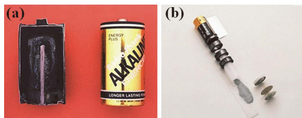
Fig. 7. 알칼리 전지의 (a)단면 및 (b)내부 구성 요소
