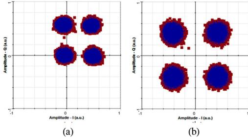
그림 6. 커플러계수 추정을 이용한 DSP 방식 보상
