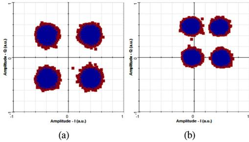
그림 3. I/Q 진폭불균형 여부에 따른 QPSK 성좌도
