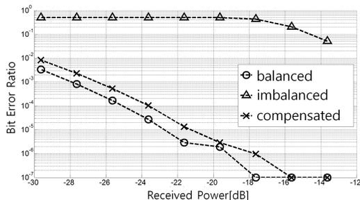
그림 7. DSP 방식 보상을 이용한 비트오율 성능 향상
