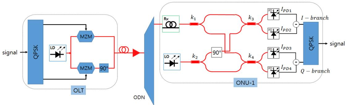
그림 1. 광 QPSK를 이용한 코히어런트 수동광가입자망
