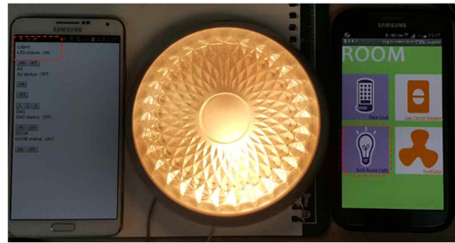
그림 13. 블루투스(가정내), 인터넷(외출중), 아두이노 시스템의 연동 구현
