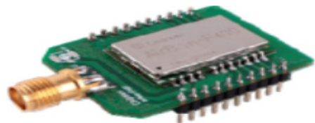
그림 6. RF 통신 모듈 Fig. 6 RF communication module
