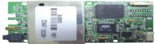
그림 4. RFID 리더 모듈 Fig. 4 RFID Reader Module
