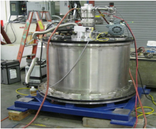
그림 5. 보잉에서 개발된 SFES 프로토타입 모듈 Fig. 5 SFES prototype module developed in Boeing
