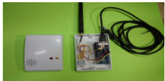
그림 10. 온도 센서 구현 결과 Fig. 10 Implementation results of temperature sensor
