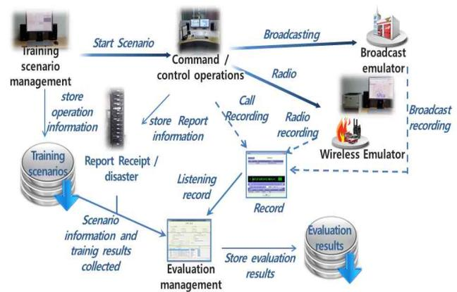
그림 4. 119 종합상황실 교육훈련시뮬레이터 시스템 흐름도
