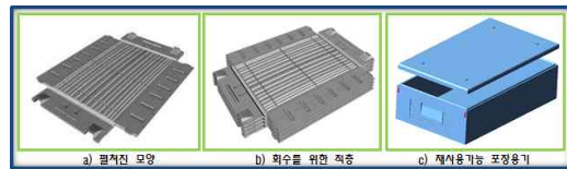
<그림 3> 반영구적 사용가능한 재사용 포장용기 출처: 국토부, 회수물류비절감을 위한 재사용 포장용기 개발, 2010.
