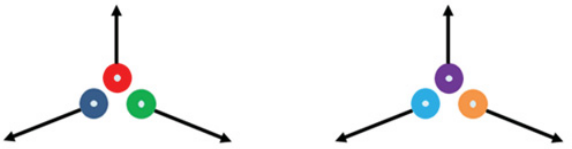
Fig. 3. 지중 2회선 삼각배열 좌우배치에서 케이블 상별 최대 전자기력의 크기와 방향
