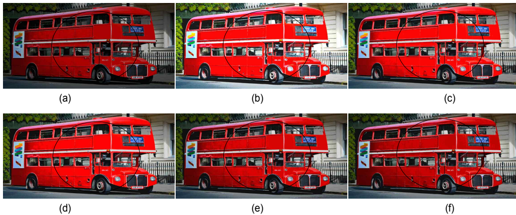
그림 1. 컬러 영상의 화질 향상 기법 비교(Redbus) (a)원영상 (b)HE 기법 (c)HM 기법 ( \lambda: 1 ) (d)HSI 컬러 공간에서 제안하는 기법( \beta: 0.25, \gamma: 0.5 ) (e)HSI 컬러 공간에서 제안하는 기법( \beta: 0.75, \gamma: 0.5 ) (f)YCbCr 컬러 공간에서 제안하는 기법( \beta: 0.75, \gamma: 0.5 )
