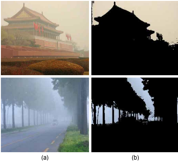
그림 4. 색 정규화를 위한 영역 추출 (a) 안개 영상 (b) 백색 검출 영역 Fig 4. Haze area extraction for color normalization (a) Haze image (b) White detection area
