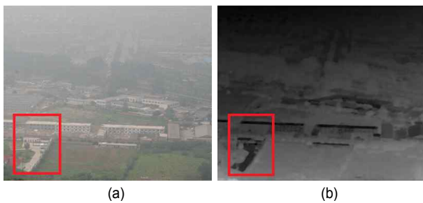
그림 2. 밝은 영역의 전달량 (a) 안개 영상 (b) 전달량 Fig 2. Transmission of high intensity area (a) Haze image (b) Transmission
