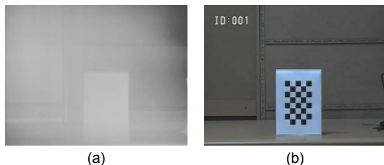
그림 1. 일반적인 체스보드를 촬영한 열화상 및 광학 영상 (a) 열화상카메라 영상, (b) 광학카메라 영상 Fig. 1 Images with a standard chessboard (a) Image of infrared thermal camera (b) Image of optical camera
