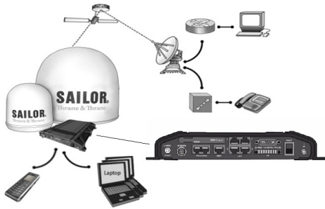
그림 6. 기존 선박용 위성 및 내부통신 시스템 테스트 구성 Fig. 6 Indoor Communication System of Vessel
