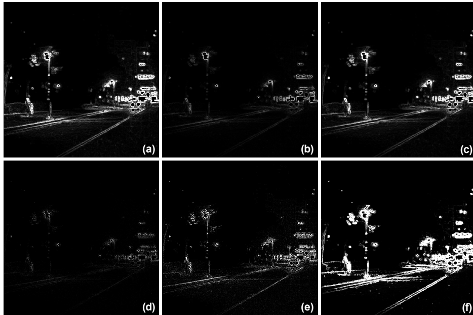
그림 4. 에지 검출 결과 (a) Sobel (b) Roberts (c) Prewitt (d) Laplacian (e) LoG (f) 제안한 알고리즘 Fig. 4 Edge detection result (a) Sobel (b) Roberts (c) Prewitt (d) Laplacian (e) LoG (f) Proposed algorithm
