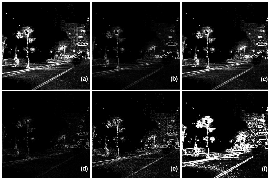
그림 5. 휘도 변환 함수를 적용한 에지 검출 결과 (a) Sobel (b) Roberts (c) Prewitt (d) Laplacian (e) LoG (f) 제안한 알고리즘 Fig. 5 Edge detection result using brightness transfer function (a) Sobel (b) Roberts (c) Prewitt (d) Laplacian (e) LoG (f) Proposed algorithm
