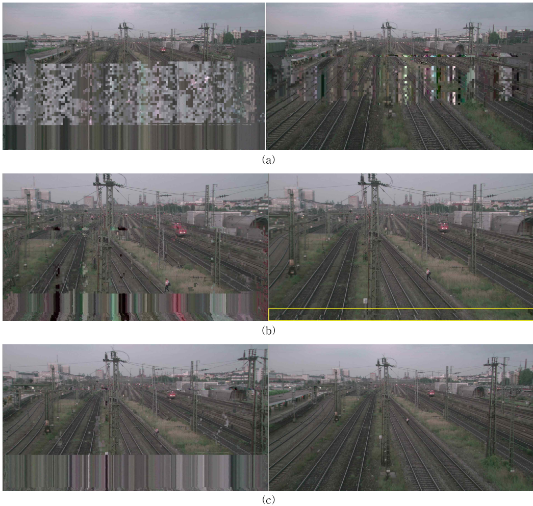
Fig. 10. Example of Video Distortion(station2) (a) BER=10^{-4} , (b) BER=10^{-4.5} and (c) BER=10^{-4} .
