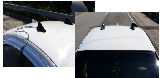
Fig. 6. Antenna attached on top of a test car 그림 6. 테스트 차량에 장착된 안테나 형태
