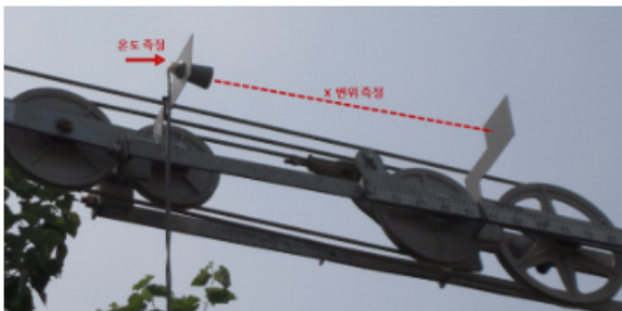
(b) 도르래 간격 측정용 초음파 센서 세부 사진
