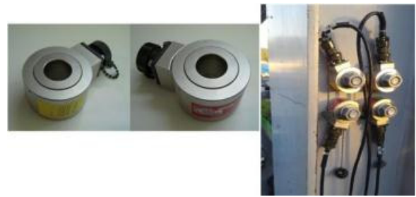
(a) 장력모니터링센서 (b) 장력모니터링센서 고정사진
