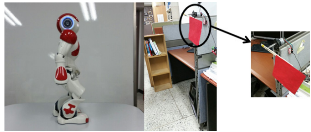
그림 12 로봇 정지 상태에서 물체 회전의 변화에 따른 색 검출 실험 방법 3 Fig. 12 Experimental method 3 of color detection with rotation variation of object with standing posture
