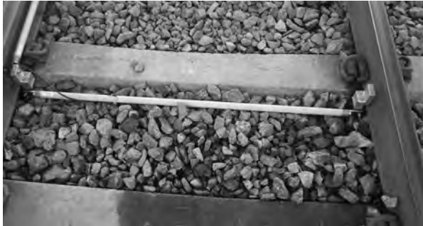
〈그림 13〉 횡방향 계측센서 설치전경
