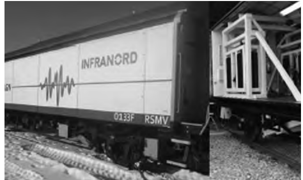
<그림 2> RSMV(왼쪽) 및 측정기구(측정 차축 위의 강제케이지(steel cages)에 들어있는 수직운동 질량)(오른쪽)
