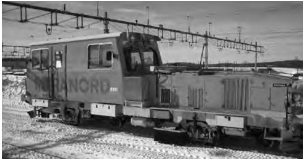
〈그림 5〉 EVS 방법으로 궤도강성도 측정할 수 있는 궤도선형검측차 IMV100
