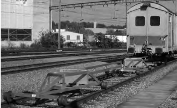
<그림 1> SBB 궤도 처짐 측정 웨건, 축중 20 톤
