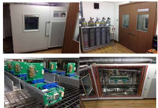
그림 6. 센서 모듈의 캘리브레이션 시험 장치 Fig. 6. Experimental setup for calibration of the sensor modules
