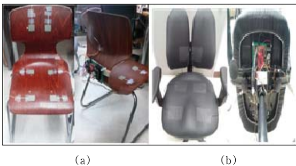
그림 4 하이팩(a) 및 듀오백(b) 스마트체어의 구조 Fig. 4 Hipack(a) and Duoback(b) smart chair structure
