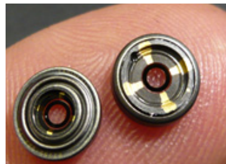
그림 2. Liquid Lens 와 신호전달 PCB Fig. 2 Liquid Lens and Flexible PCB
