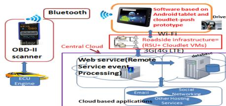
**그림 4.** 원격 차량 진단 모바일 응용 프로그램의 시스템 설계
