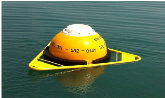
그림 2. OE-700 파고, 파향 측정 시스템 Fig. 2 OE-700 Wave Monitoring System
