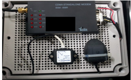
그림 3. 파고 계측 및 데이터 로거 시스템 Fig. 3 Data Logger and Sensors
