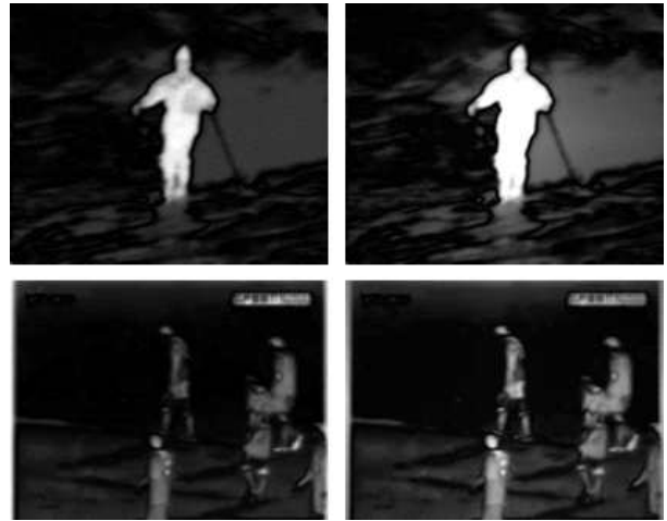
그림 4. 근접 모델의 효과. (a) Zhai의 관심맵[4] 및 (b) 근접 모델을 적용한 관심맵 Fig. 4. The effect of affinity model. (a) saliency map [1] and (b) saliency map improved by affinity model
