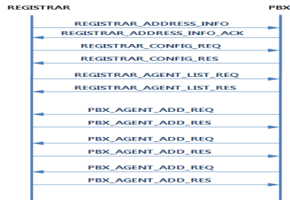
그림 7. REGISTRAR가 부팅 시 처리 알고리즘 Fig. 7. The processing algorithm when REGISTRAR is booting
