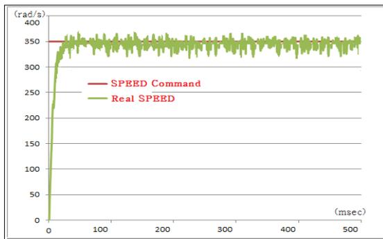
그림 17. 350rad/s(120rpm) 속도지령에 대한 응답 특성
