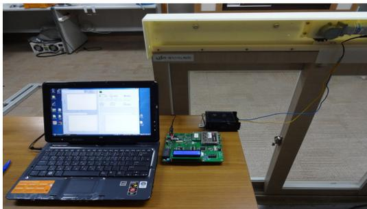
그림 9. 개발된 창호 원격관제 시스템 시작품
