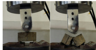
(d) splitting for inspection
