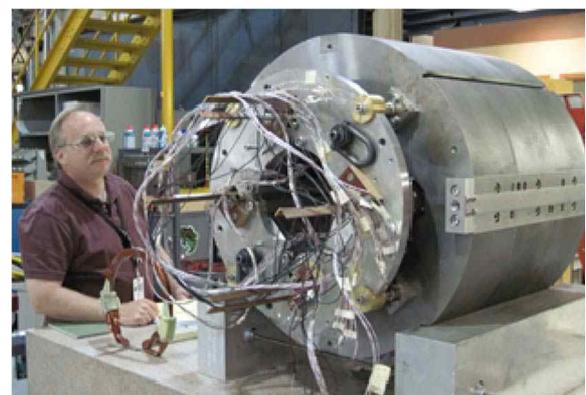
그림 2. Fully assembled FRIB quadrupole HTS magnet, BNL [2].
