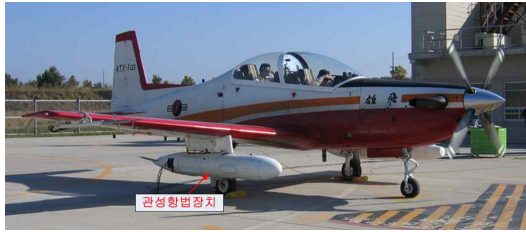
그림 6. 항공기 탑재시험. Fig. 6. Captive Flight Test.
