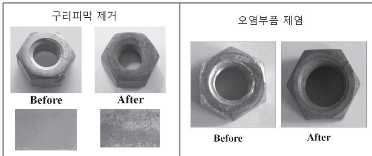
그림 4 질산-이산화탄소 마이크로에멀션으로 수행한 구리피막제거 실험 전후의 시편모습과 방사능 오염부품 제염실험 전후의 시편모습
