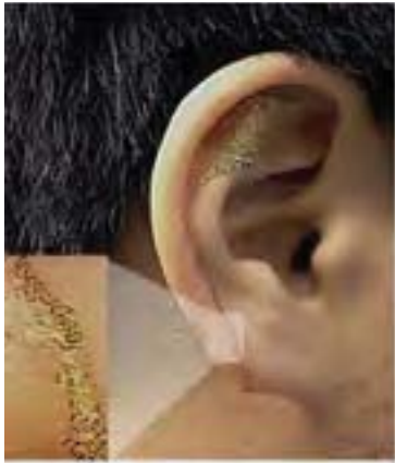
〈그림 3〉 뇌파 측정을 위한 피부형 전자기기 (epidermal electronics) [16]
