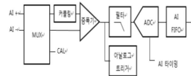
그림 7 DAQ 장치 아날로그 입력 블록다이아그램 Fig. 7 Block diagram of analog input for DAQ device
