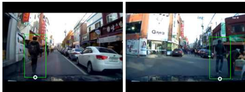
그림 2. HOG를 이용한 보행자 검출 결과 Fig. 2. Pedestrian detection results using the HOG method
