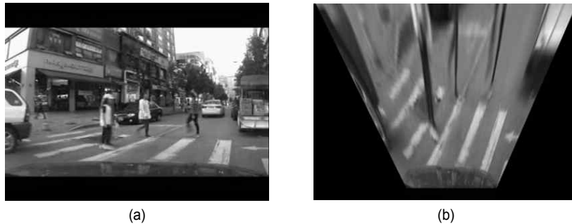
그림 4. 탑뷰 변환 영상 (a) 입력 영상 (b) 변환 영상 Fig. 4. The transformed top-view image (a) input image (b) transformed image
