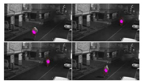
그림 10. 골목길 시니라오 대한 보행자 추적 결과 Fig. 10. The result of pedestrian tracking for alley scenario
