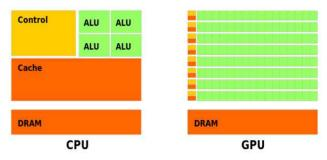
그림 5. CPU와 GPU의 하드웨어 구조 Fig. 5. Hardware architecture of CPU and GPU
