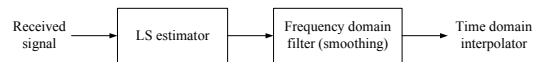
그림 5. 주파수 영역 필터링의 채널 추정기 Fig. 5. Channel estimator of frequency domain filtering
