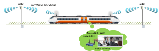
그림 1. 모바일 핫스팟 네트워크 구조 Fig. 1. Mobile hotspot network structure
